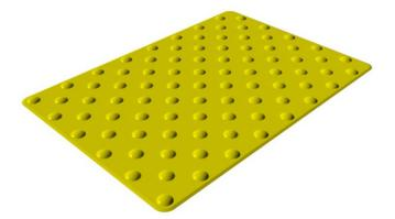
Dalle podotactile à reliefs sphériques disposés en ligne diagonales avec une hauteur de 5 mm, avec espacement entre les points, témoins d'usure, classement feu / fumée, antidérapance conforme à la norme Française NF P98-351. Revêtues d'un relief antidérapant spécifique sur les sphères Construites avec un technipolymère de M-PVC-P à hautes prestations, ayant les caractéristiques techniques suivantes.
