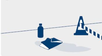
Signalez la zone à protéger durant les travaux. Évacuez les poussières à la surface du sol. Sur enrobé, utilisez un racloir. Séchez le sol si besoin. Dégraissez les sols en intérieur et poncez très légèrement les sols lisses en extérieur.
