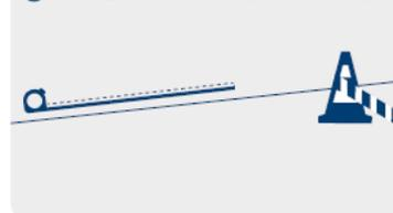
Signalez la zone à protéger durant les travaux. Évacuez les poussières à la surface du sol. Séchez le sol si besoin. Veillez à respecter les lois, normes et recommandations d'implantation en vigueur.
