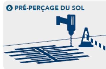
Recoupez si besoin chaque profilé à la longueur souhaitée à l'aide d'une scie à métaux. Percez et fraisez les profilés à 3 cm de leur bord puis tous les 10 cm à l'aide d'une mèche type HSS de diamètre 4,5 mm.
