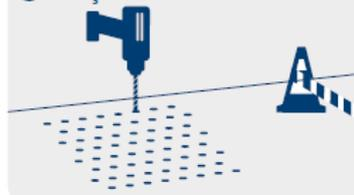
Positionnez le gabarit et fixez-le au sol. Placez les plots dans les trous du gabarit. En cas de chevillage, marquez le sol au travers des plots. Retirez les plots et percez le sol (diamètre 3 mm). Sinon, vissez directement les vis dans les plots (vis inox de 3,5 mm à tête fraisée cruciforme ou Torx, de 25 à 30 mm, non fournies).
