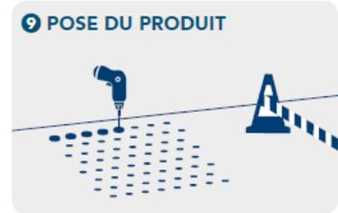
Aspirez les poussières en surface du sol et dans les trous précédemment percés. En cas de chevillage, insérez les chevilles (non fournies). Sinon, passez directement à l'étape 10. Vissez les plots (vis inox de 3,5 mm à tête fraisée cruciforme ou Torx, de 25 à 30 mm, non fournies).
