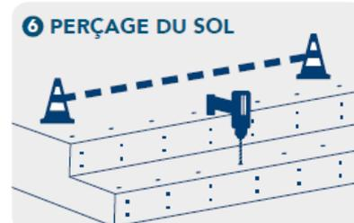
Recoupez si besoin chaque profilé à la longueur souhaitée à l'aide d'une scie à métaux. Percez et fraisez les profilés à l'aide d'une mèche type HSS de diamètre 4,5 mm, à 3 cm de leur bord puis tous les 20 cm pour les profilés larges (59, 62 et 100 mm) ou tous les 10 cm pour les profilés plus fins (39 et 46 mm). Marquez légèrement le sol au travers des trous du profilé. En cas de chevillage, percez le sol (diamètre 3 mm). Sinon, passez directement à l'étape 7.
