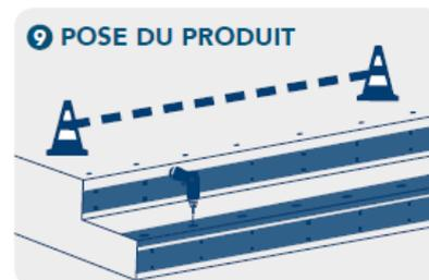
Aspirez les poussières en surface du sol et dans les trous précédemment percés. En cas de chevillage, insérez les chevilles (non fournies). Vissez les profilés (vis inox de 3,5 mm à tête fraisée cruciforme ou Torx de 20 à 25 mm, non fournies).
