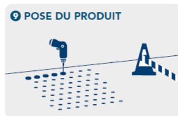
Aspirez les poussières en surface du sol et dans les trous précédemment percés. En cas de chevillage, insérez les chevilles (non fournies). Sinon, passez directement à l'étape 10. Vissez les plots (vis inox de 3,5 mm à tête fraisée cruciforme ou Torx, de 25 à 30 mm, non fournies).
