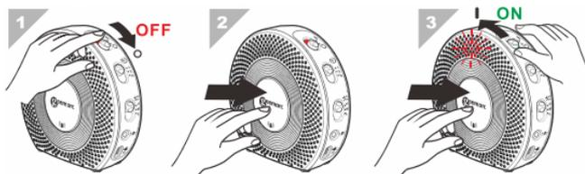
1 Mettez l'interrupteur en position **ARRÊT**.
