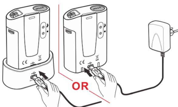
**Chargement à l'aide du support de connexion** – Branchez le câble d'alimentation USB de type C au support de connexion. Mettez le récepteur sur le support de connexion.
