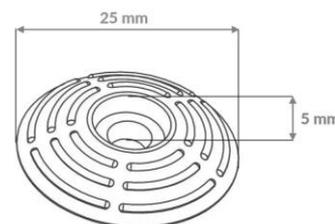
Pour couvrir une surface podotactile de 1m, il faut utiliser 150 clous pour 40 cm de large, 225 clous pour 60 cm de large.
